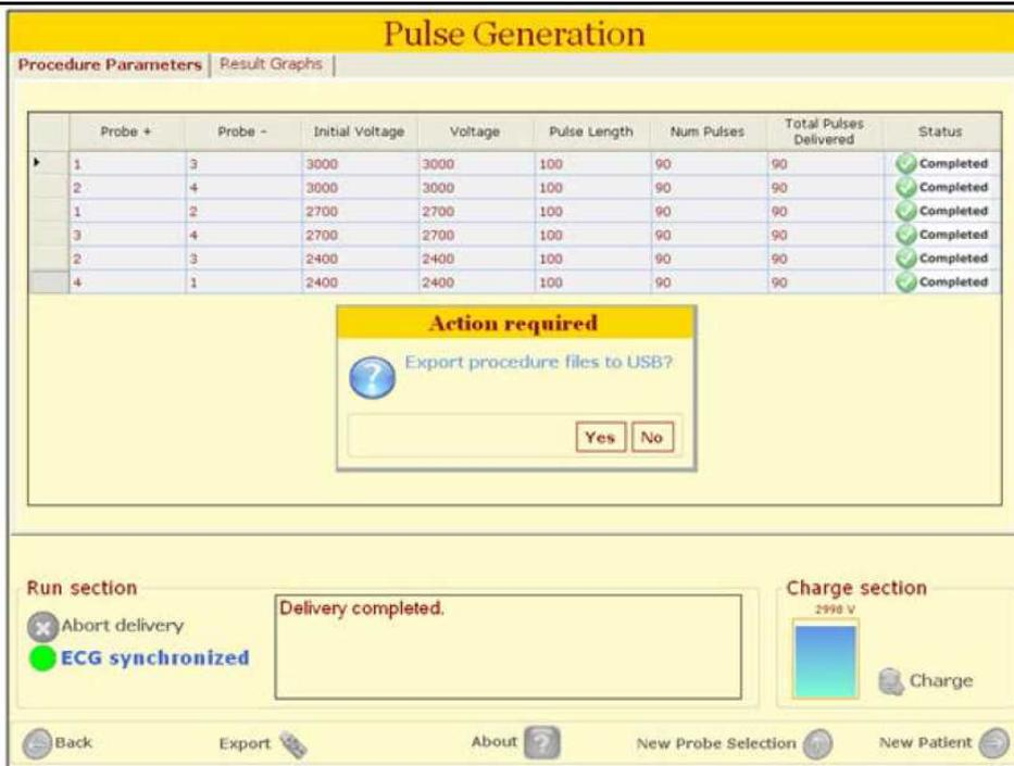
図 8. Pulse Generation 画面 (Procedure Parameters) : 全ての電極針間からパルスが発生されたことを確認。
