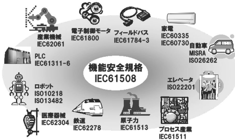
図 2-4 IEC 61508 から派生した主な機能安全規格（三菱電機作成資料）
