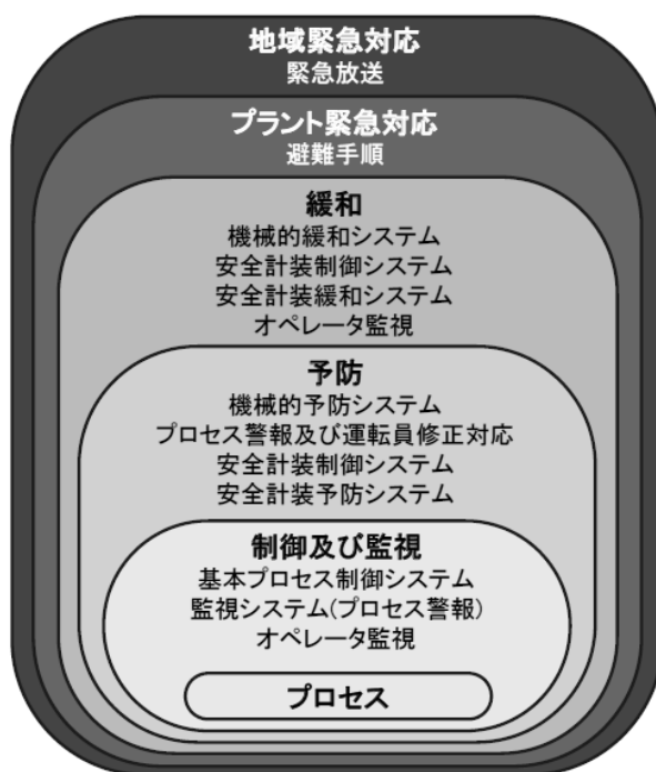
図 5-36 プロセスプラントに見られる一般的なリスク軽減法
