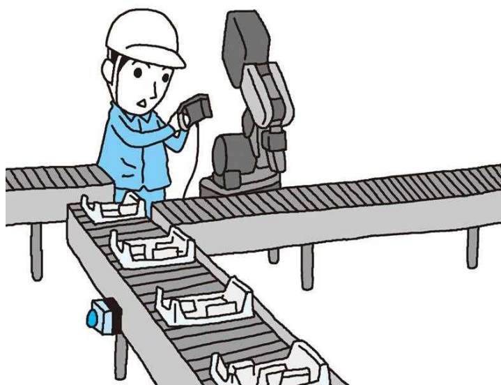
図 8-5 ペンダント(3ポジションイネーブルスイッチ)の設備例
