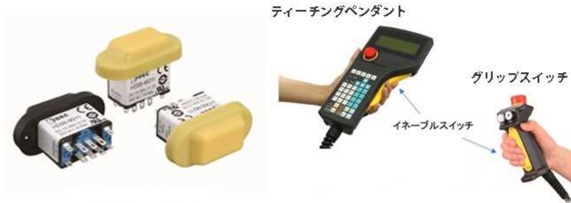
図 5-5 イネーブルスイッチ及びイネーブルスイッチを使用したティーチングペンダントとグリップスイッチ(IDECC ホームページより)
