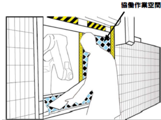
図 2-8 安全適合監視停止システム
