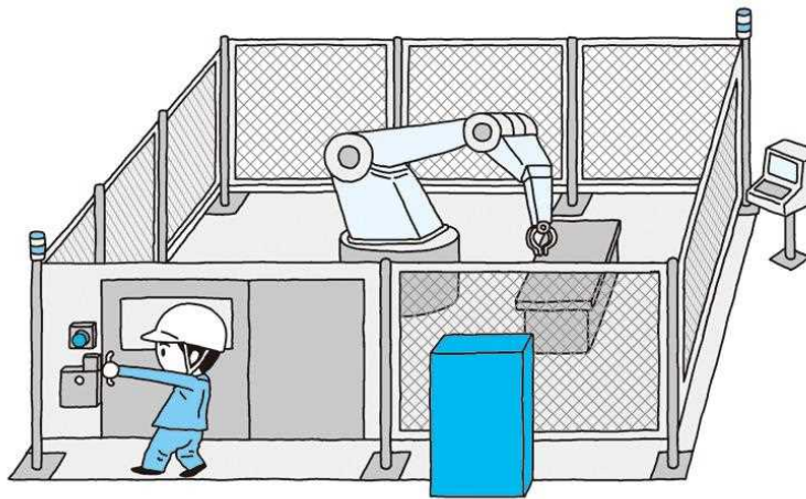
図 8-1 施錠式インタロックの設備例
