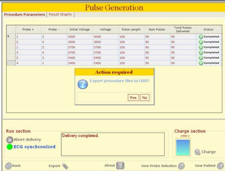
図 8. Pulse Generation 画面 (Procedure Parameters) : 全ての電極針間からパルスが発生されたことを確認。
