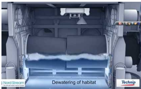
ドライチャンバー内排水状況(Technip)
