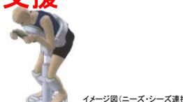
・ロボット技術を用いてトイレ内での下衣の着脱等の排泄の一連の動作を支援する機器
