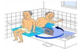
・ロボット技術を用いて浴槽に出入りする際の連続動作を支援する機器
