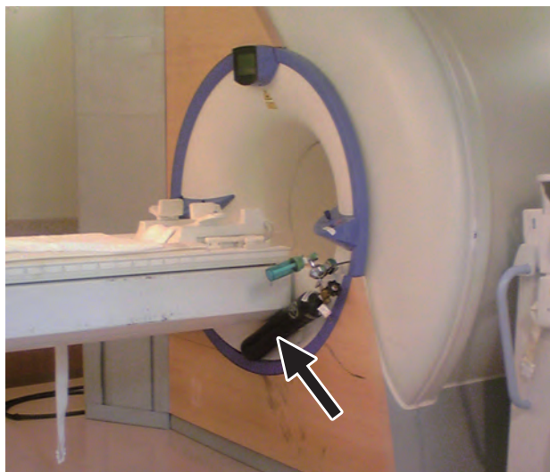
図表Ⅲ - 3 - 10 MRI装置にボンベが吸着した事例（第13回報告書144～145頁）
