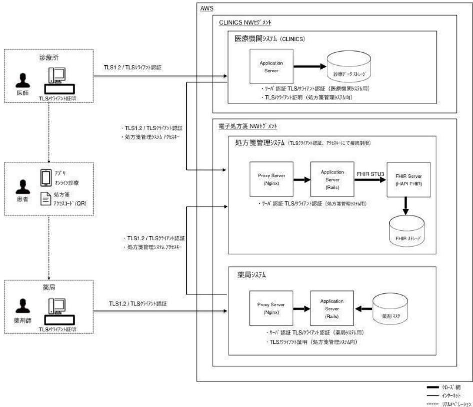
図12: 評価システムのシステム構成
