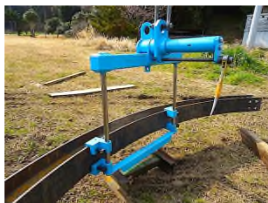
▲高年齢労働者の提案により生まれた「H鋼リング用吊り具」
