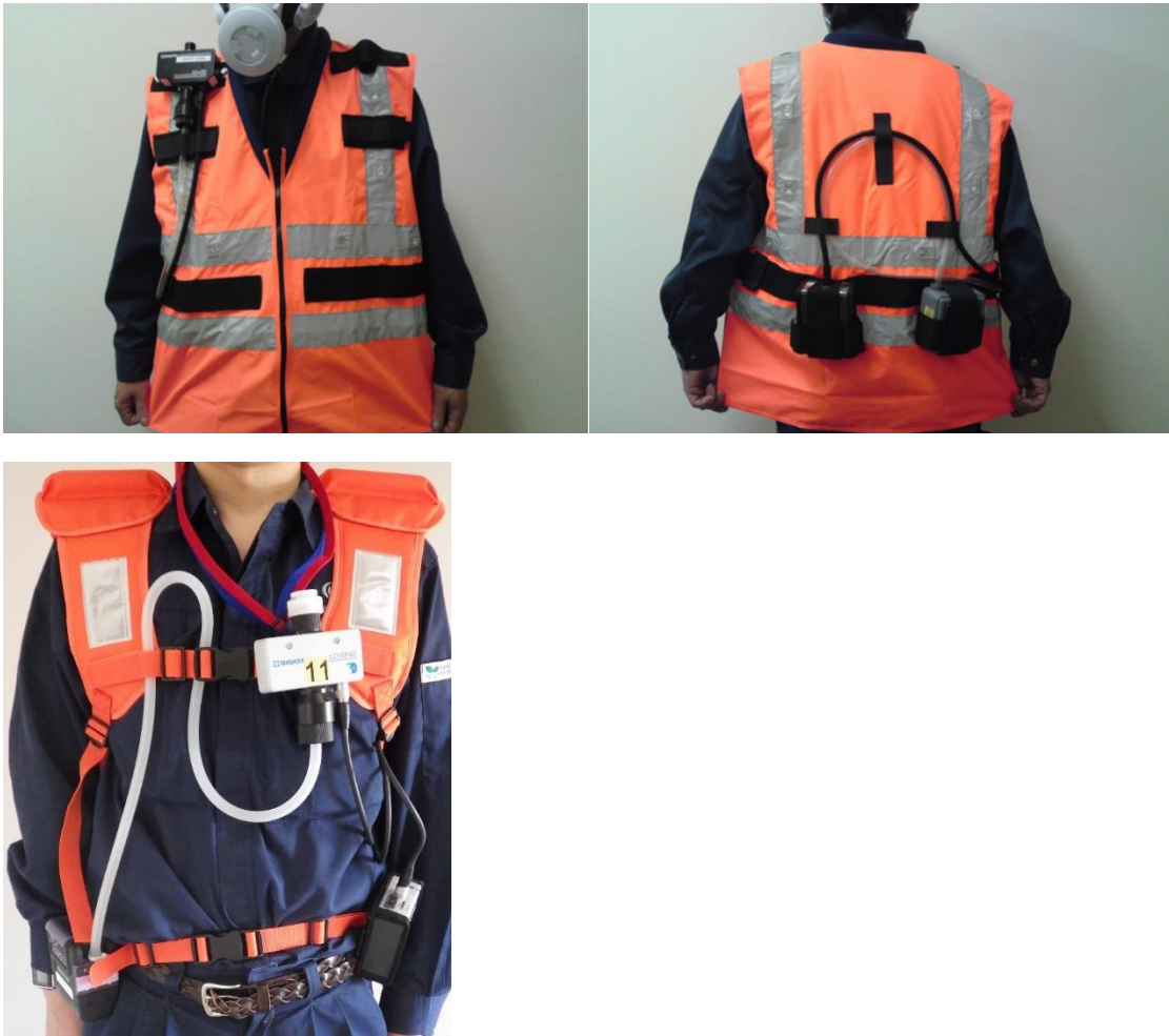
図3 個人サンプラー装着例（上）専用ベスト（下）バックプロテクター
