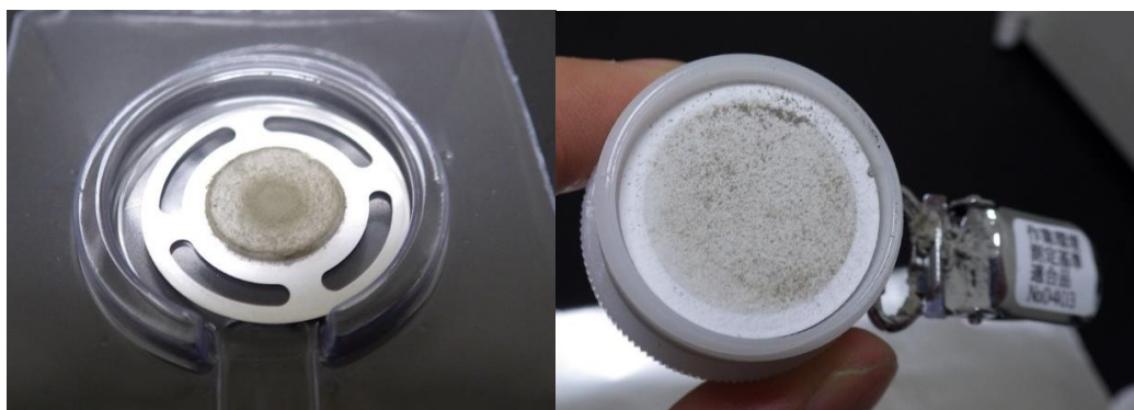
図 7 現場 A 二次吹付け作業時の重機の測定で使用された衝突板（左）及びフィルター（右）
