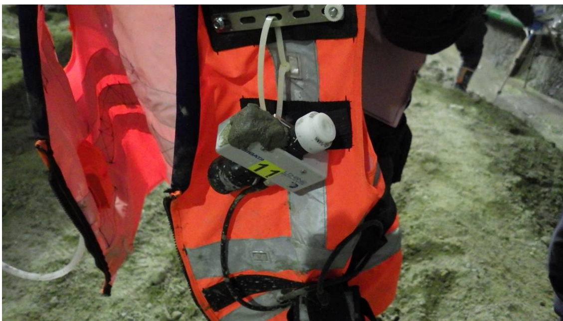
図 17 作業中にセメントミルクが付着して使用不能となった装置
