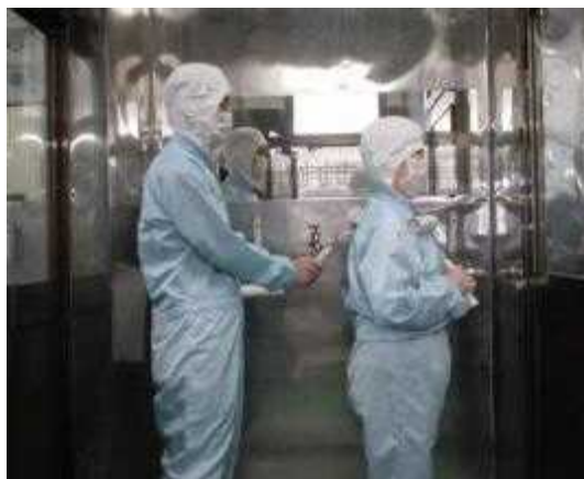
▲ネット帽・頭巾着用者による粘着ローラー掛けの様子（例）
