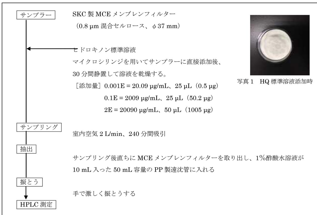
図 3 基本捕集操作フロー (添加回収試験)
