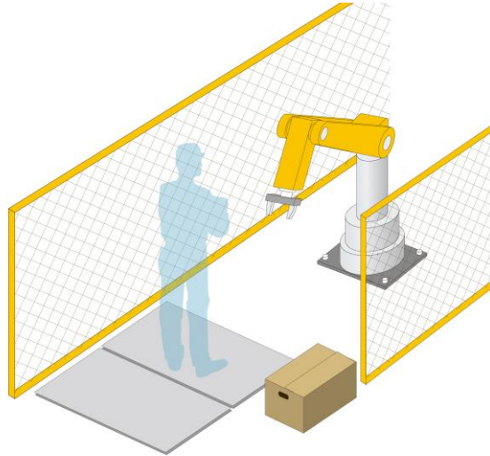
図 6-13 圧力検知マットスイッチ事例
