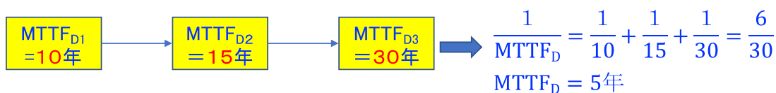
図 6-5 同一チャンネル全体の MTTF (MTTF D ) の計算式と計算事例
