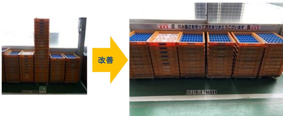
図3-3 表示による危険個所の解消事例
