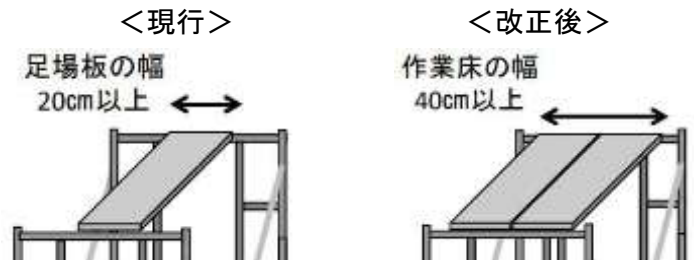
図4-7 足場板の対策
