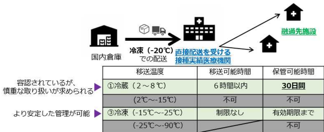
図 32② 武田/モデルナ社のワクチンの配送・保管温度の関係
