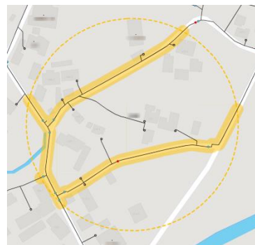
漏水可能性エリアのアプリ表示例
