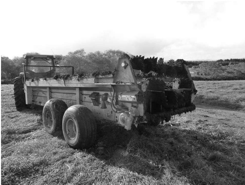
図4 使用していたマニュアルスプレッダ (タイヤ断面形状が丸く、溝に堆肥が詰まっていた)
