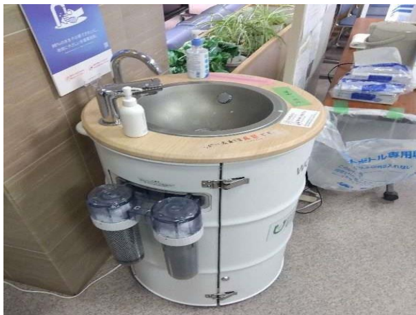
水循環型手洗いスタンド（志賀町）
