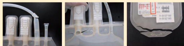
FFPバッグの破損事例
